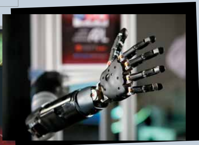
Механическая рука-робот сконструирована в лаборатории прикладной физики Университета Джона Хопкинса (JHU/APL). Фото DARPA и JHU/APL
